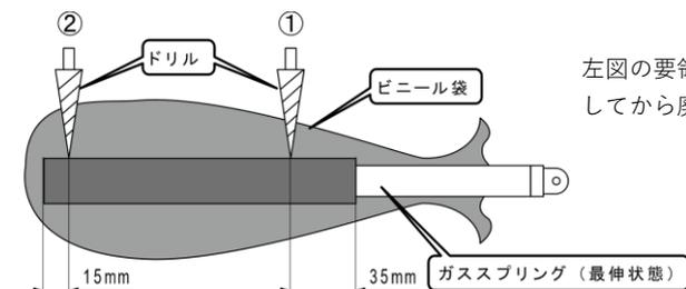
左図の要領で孔をあけ、ガス抜きをしてから廃棄処分して下さい。
